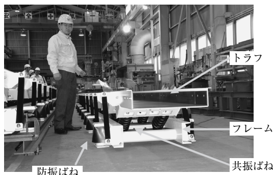
図3 2質量タイプのコンベヤの構造と動き
